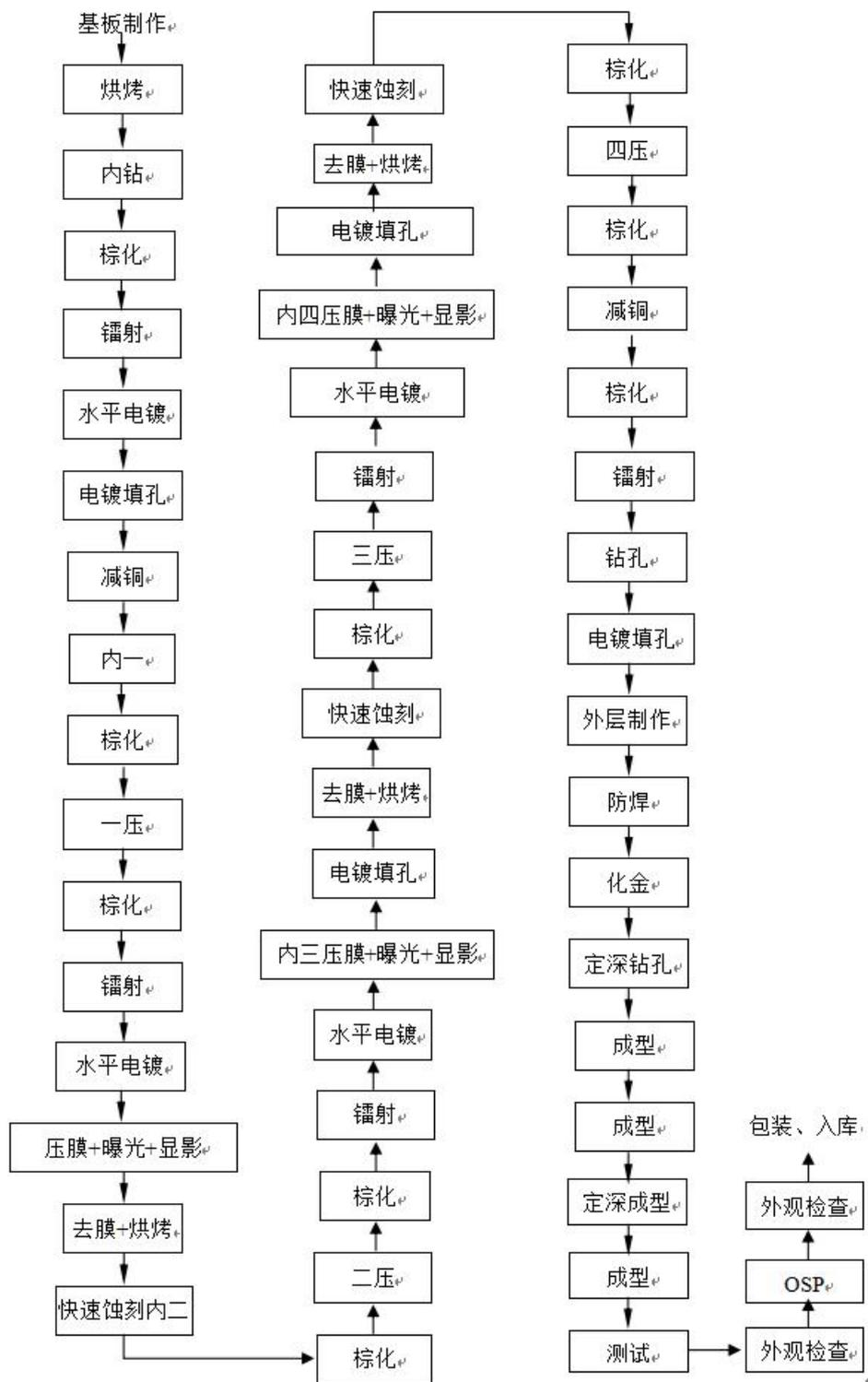
图3.3.2-1 SLP电路板整体工艺流程
