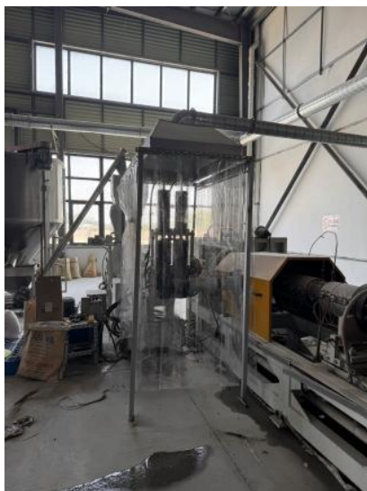
图 7.1-1 本次扩建项目工艺废气收集示意图
