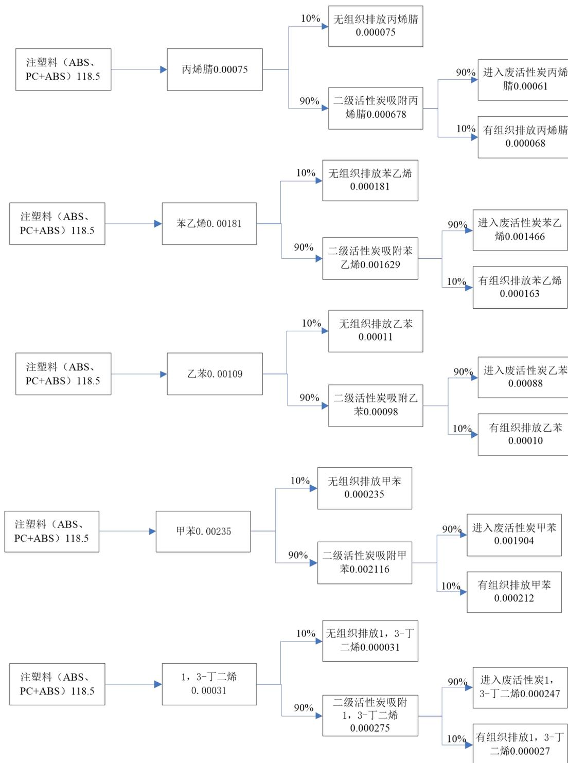
图 4.4-2 注塑生产线苯乙烯、丙烯腈、乙苯、甲苯、1,3-丁二烯物料平衡图 (单位: t/a)
