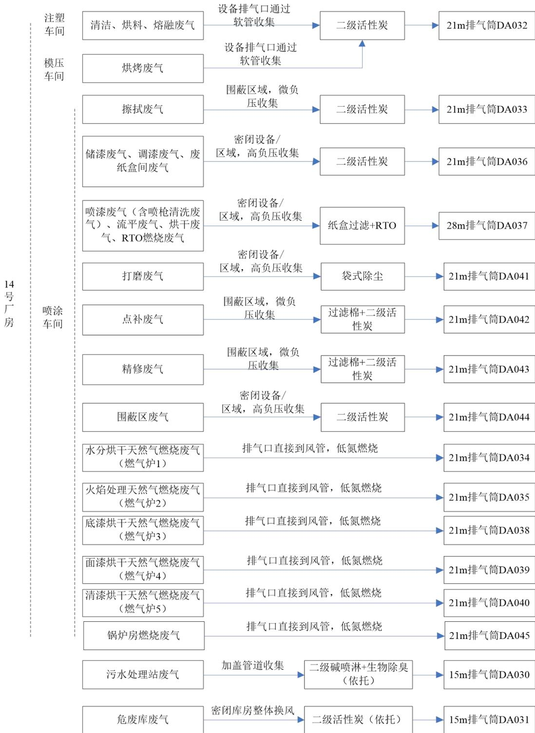
图 7.1-1 生产线废气收集处理流程示意图
