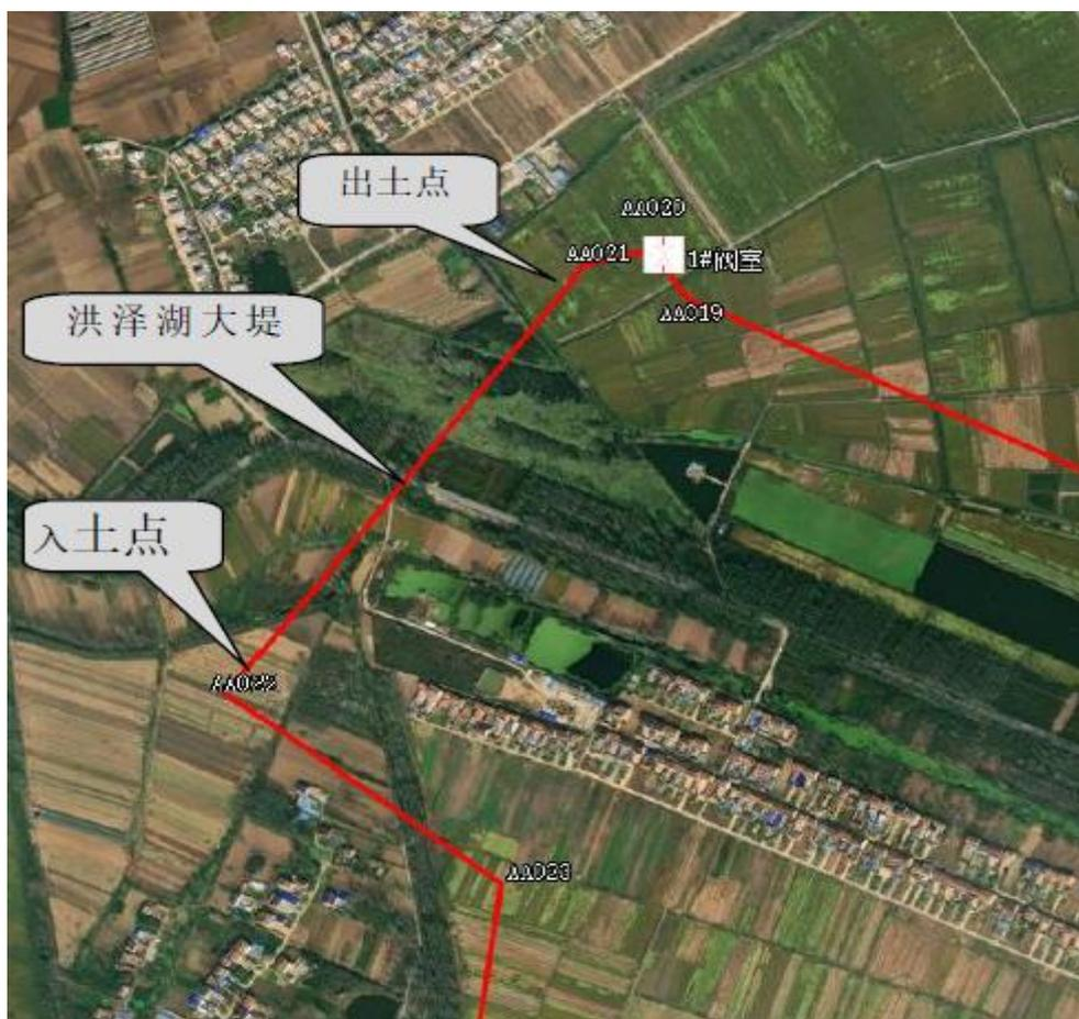
图 3.3-22 管道穿越洪泽湖大堤位置图
