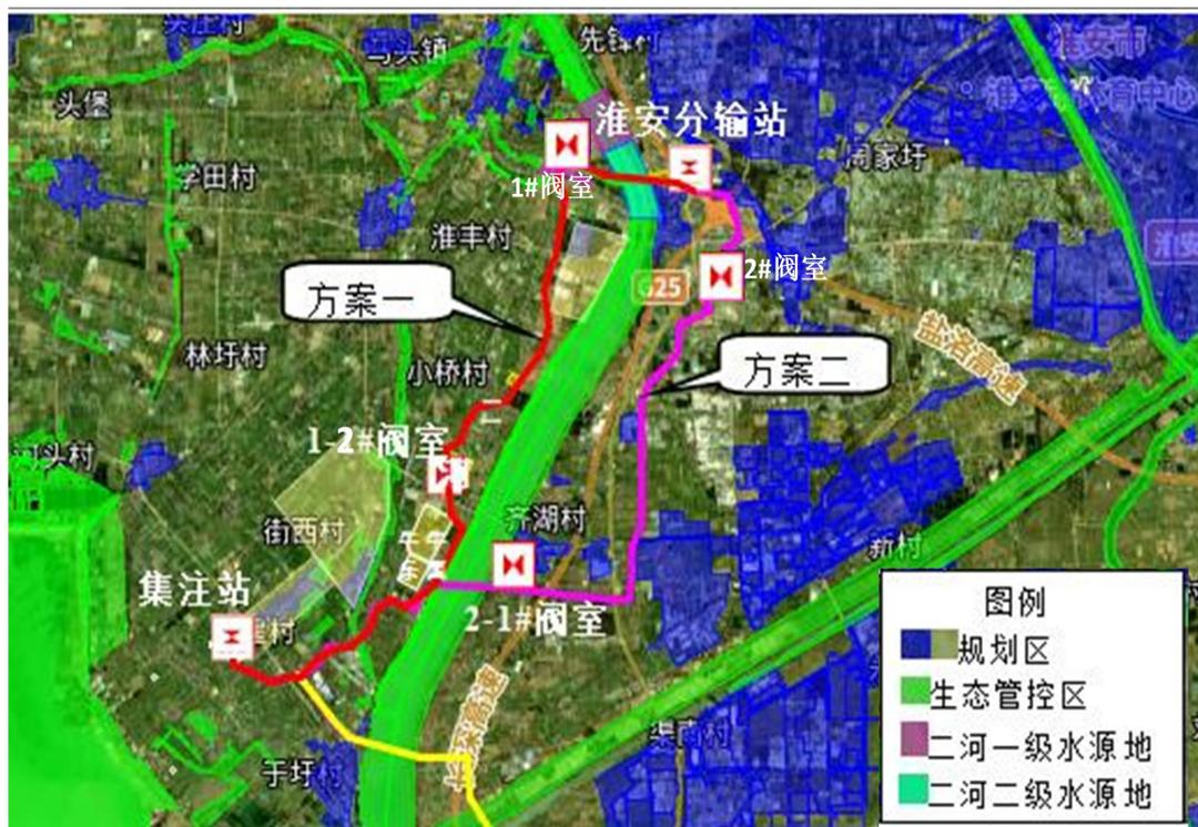
图 1.3-4 双向输送管道路由比选示意图
