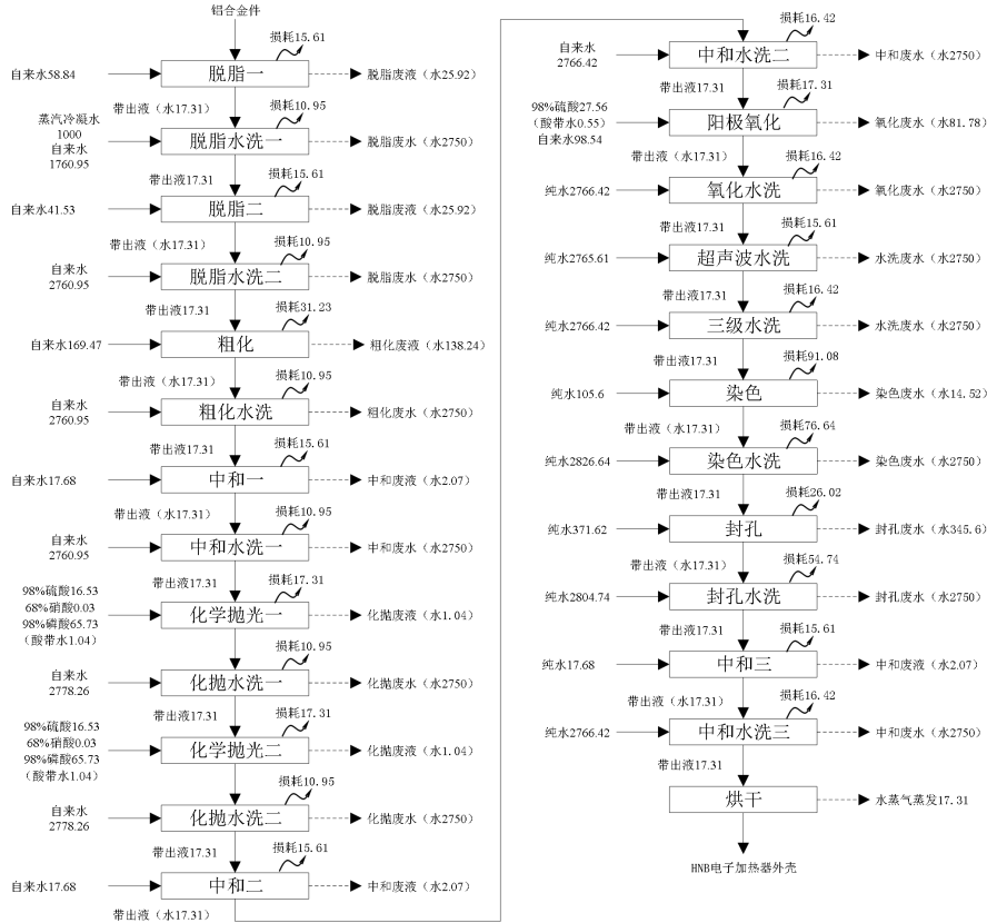
图 3.3.2-7 项目二期自动阳极氧化线水平衡单位：t/a
